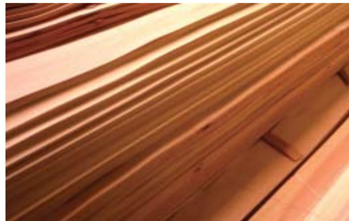
sie auch gepresst, um sie durch diesen Bügeleffekt glatt zu bekommen. Anschließend werden die Kanten beschnitten und die sauberen Furnierpakete vermessen. Zuletzt sortieren die Furnierhersteller die Pakete zu verschiedenen Qualitätsklassen und bewerten diese.
