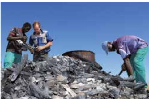
Farmer Stefan Gaugler prüft mit seinen Angestellten die Qualität der fertigen Holzkohle. Ist diese abgekühlt, kann sie in Säcke gefüllt werden.
